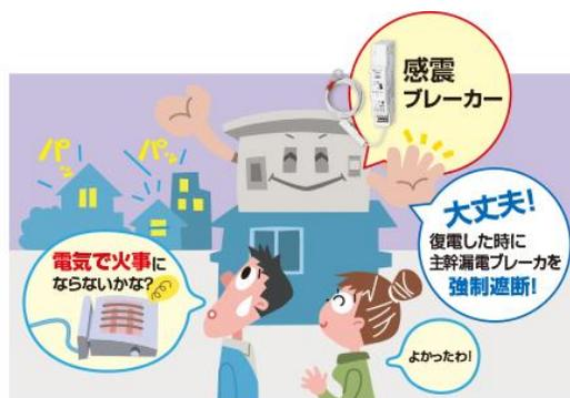
感震ブレーカーが通電火災の二次災害の防止に役立ちます。
